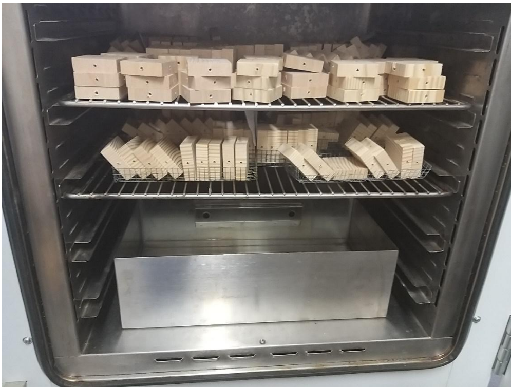
Slika 6. Sušionik s uzorcima koji je ujedno služio i kao klima komora za kondicioniranje uzoraka
