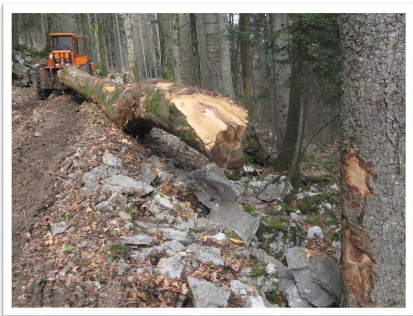
Slika 7. Oštećenje kore tijekom privlačenja drva skiderom
