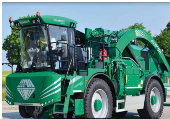
Slika 2. Samohodni iverač - Albach
