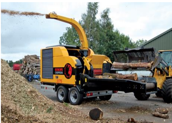
Slika 1. Iverač ugrađen na poluprikolicu
