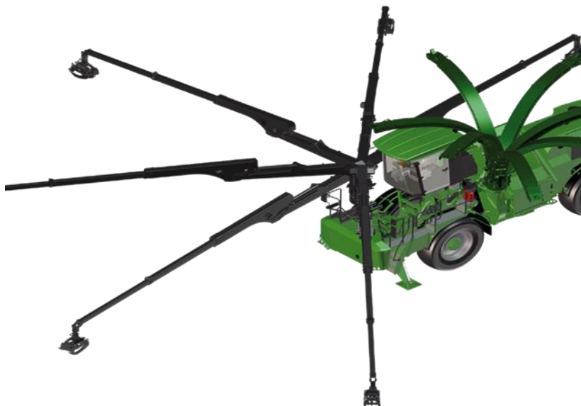
Slika 13. Prikaz radijusa okretanja kрана dizalice i tornja za istovar ( http://www.albach-maschinenbau.de/de_DE/ )
