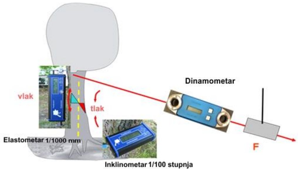
Slika 9. Dijelovi sustava TreeQinetic (Paulić, 2015)
