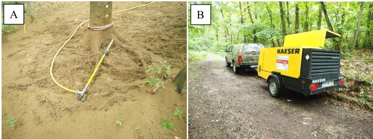
Slika 12. A) Uređaj Airspade. B) Kompresor za pogon Airspade uređaja
