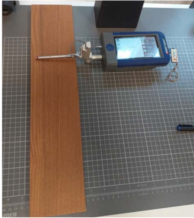
Slika 7. Mjerenje hrapavosti okomito na vlakanca drva
