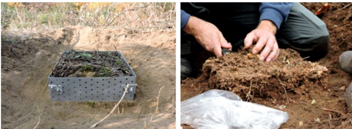
Slika 12. Uzorkovanje šumske prostirke unutar okvira 30 x 30 cm na kontrolnoj plohi (lijevo) i u kulturi crnog bora (desno) (Foto: E. Bajramspahić, 2018.)
