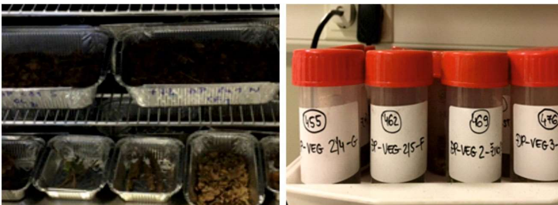
Slika 13. Sušenje uzoraka u sušioniku (lijevo) i pripremljeni poduzorak za suho spaljivanje (desno) (Foto: E. Bajramspahić, 2019.)
