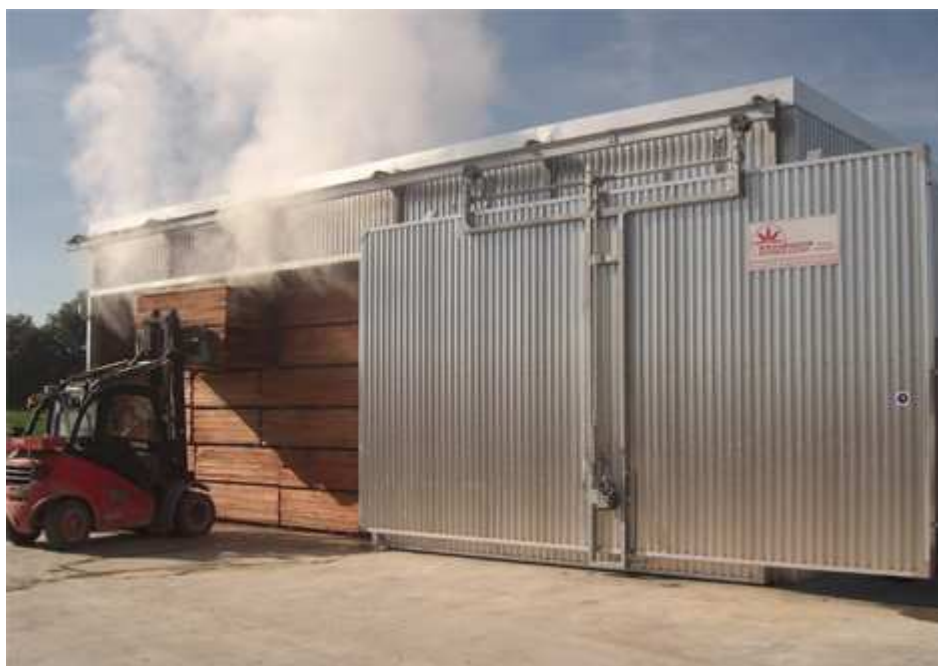
Slika 1. Parenje piljenica zasićenom vodenom parom (izvor: Termolegno, 2019)
