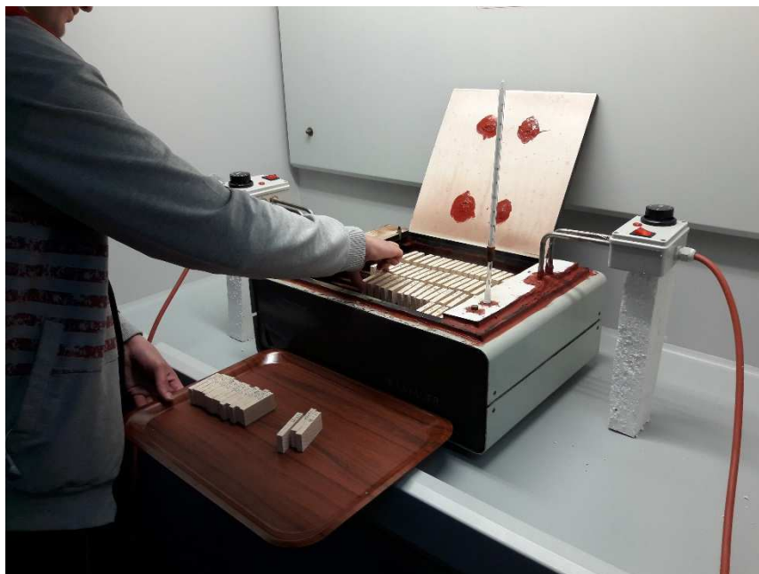
Slika 19. Priprema uzoraka za proces parenja vodenom parom.
