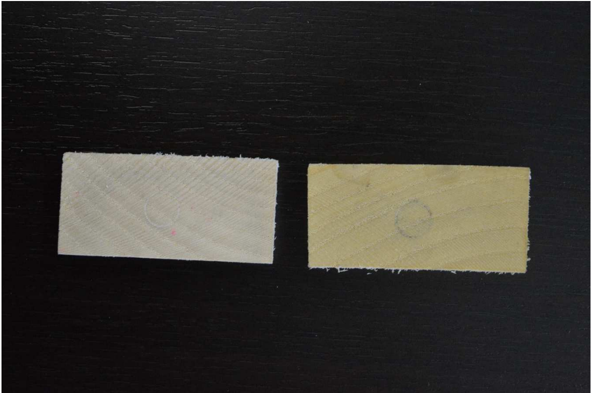
Slika 27. UV tretirani uzorak (desno) i UV netretirani uzorak (lijevo) nakon parenja.
