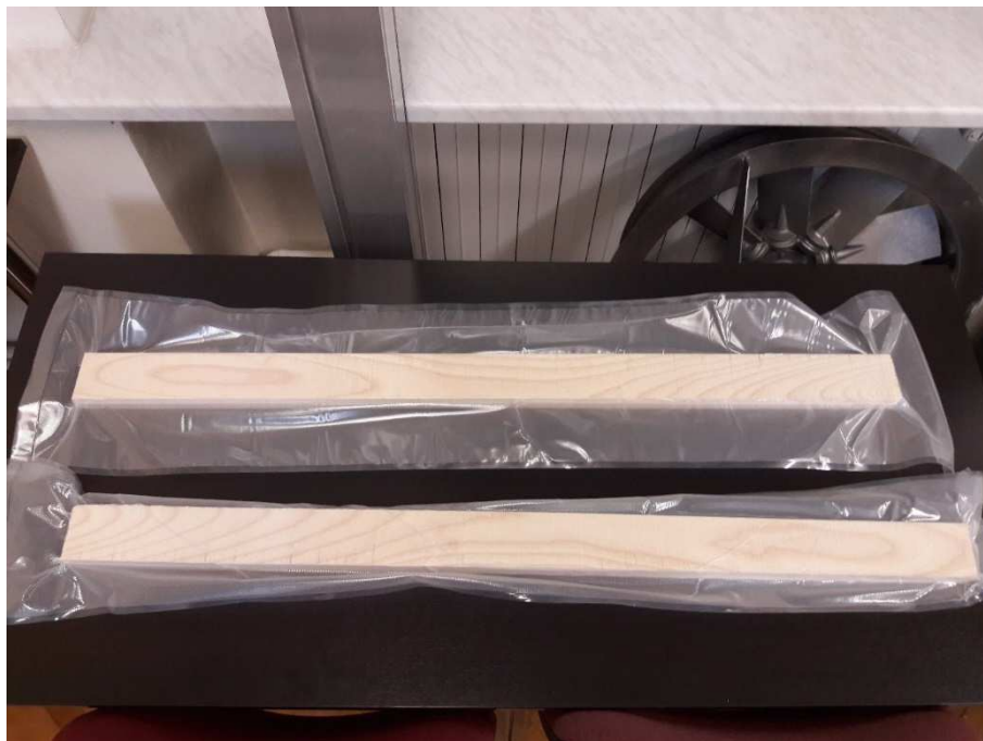
Slika 12. Ispiljeni i vakuumirani uzorci drva jasena.
