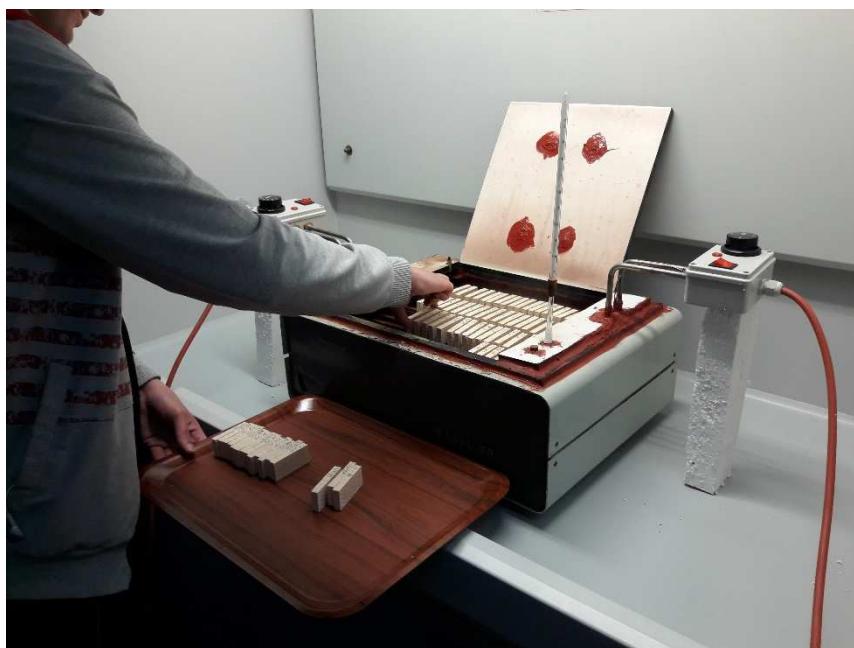
Slika 19. Priprema uzoraka za proces parenja vodenom parom.
