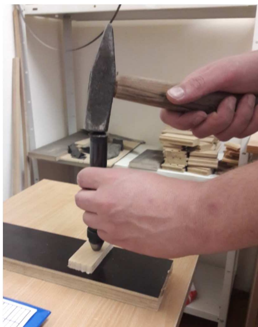
Slika 13. Označavanje uzorka probijačem.
