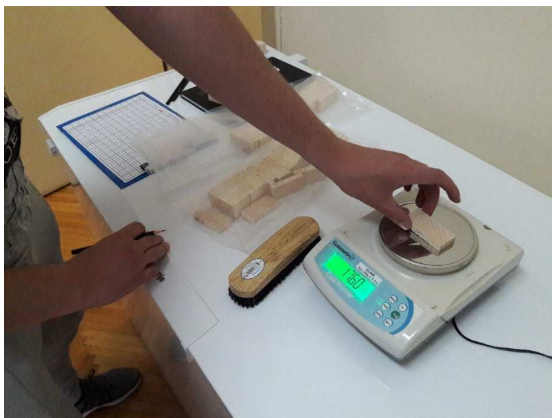
Slika 14. Četkanje i vaganje uzoraka.
