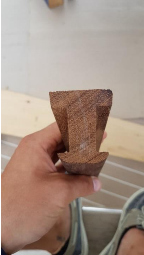
Slika 21. Drveni spojevi za plastične panele. Izvor: Pečarina, 2019.
