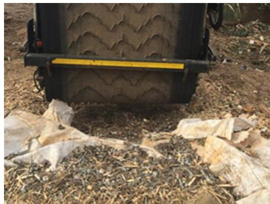
Slika 7. Odvajanje metalnih frakcija magnetom
