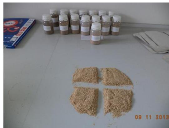
Slika 9. Priprema uzorka četvrtinskom metodom
