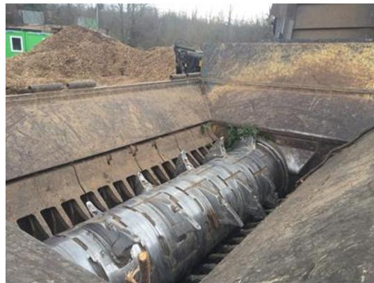
Slika 5. Rotor za usitnjavanje lomljjenjem
