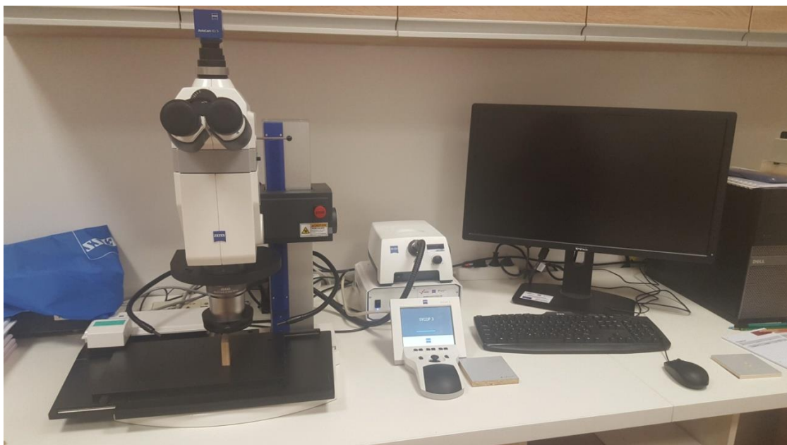
Slika 12. Mikroskop za mjerenje suhe debljine filma premaza
