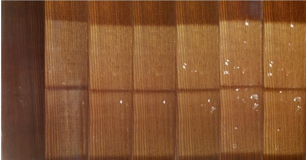
Slika 34. Uzorci T-A-1-2 (tijekom izlaganja od 1h, 168h, 336h, 504h, 672h, 840h, 1008h)
