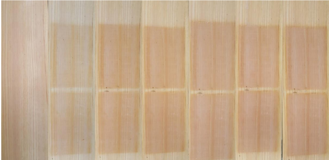
Slika 49. Uzorci N-G-1-2 (tijekom izlaganja 1h, 168h, 336h, 504h, 672h, 840h, 1008h)
