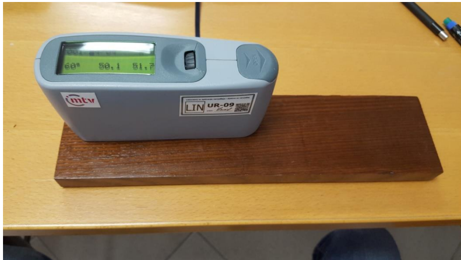
Slika 11. Uređaj za mjerenje sjaja tvrtke KSJ
