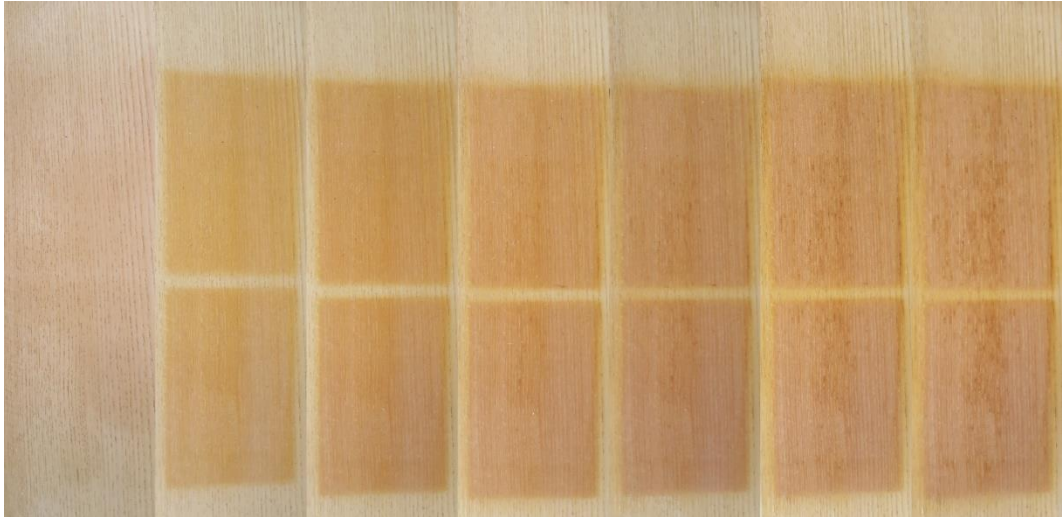
Slika 47. Uzorci N-E-1-2 (tijekom izlaganja 1h, 168h, 336h, 504h, 672h, 840h, 1008h)
