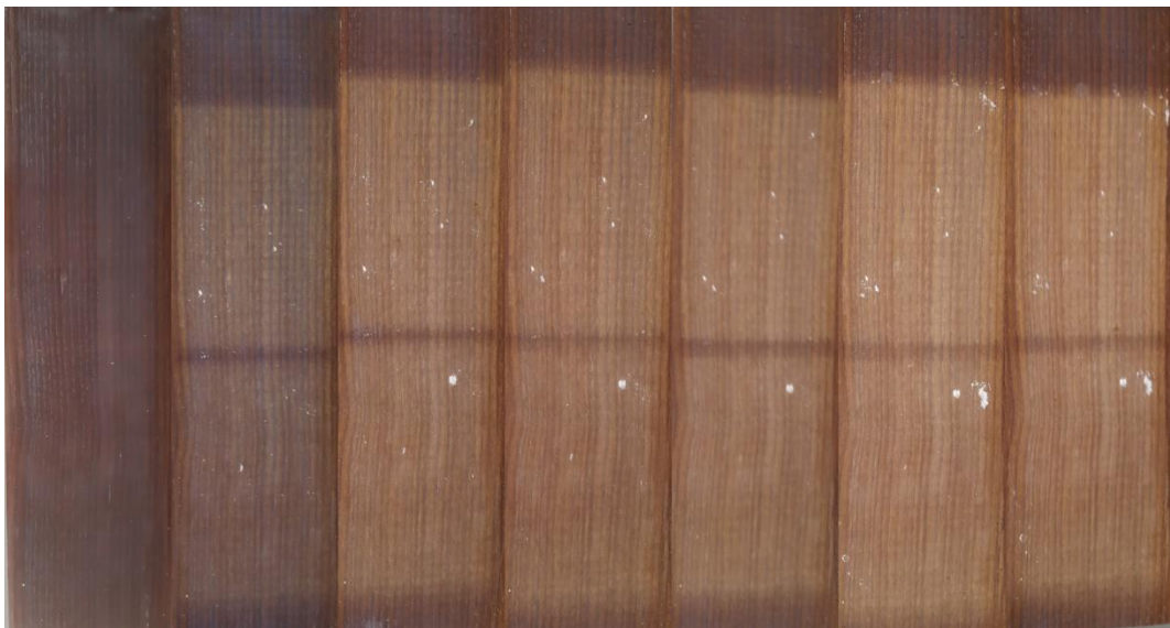
Slika 37. Uzorci T-D-1-2 (tijekom izlaganja od 1h, 168h, 336h, 504h, 672h, 840h, 1008h)
