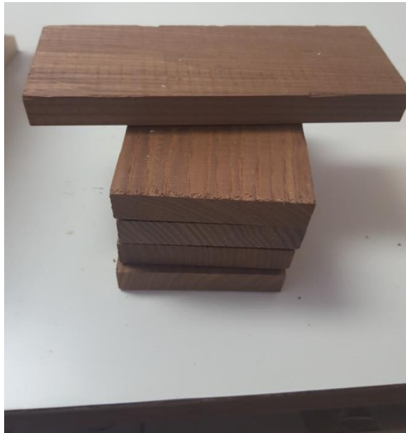
Slika 4. Toplinski modificirani uzorci drva jasena
