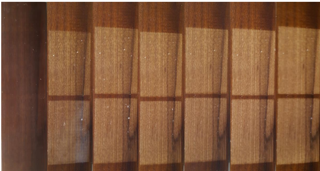
Slika 39. Uzorci T-F-1-2 (tijekom izlaganja od 1h, 168h, 336h, 504h, 672h, 840h, 1008h)
