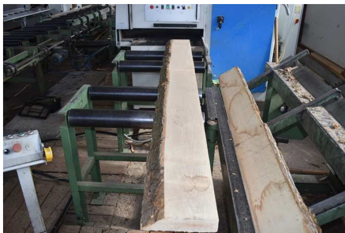
Slika 3. Raspiljivanje jasenovih piljenica na višelisnoj kružnoj pili.
