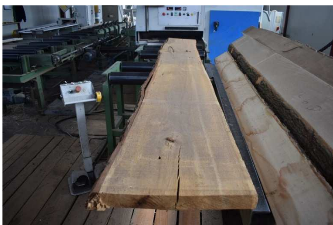
Slika 5. Raspiljivanje hrastovih piljenica na višelisnoj kružnoj pili.
