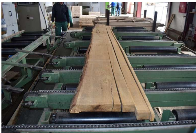
Slika 6. Hrastove greduke raspiljene na višelisnoj kružnoj pili.
