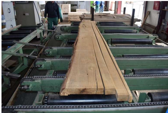
Slika 6. Hrastove greduke raspiljene na višelisnoj kružnoj pili.
