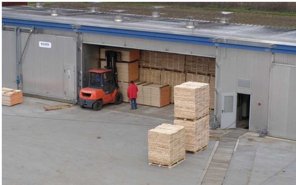
Slika 1. Prikaz komorne sušionice.
