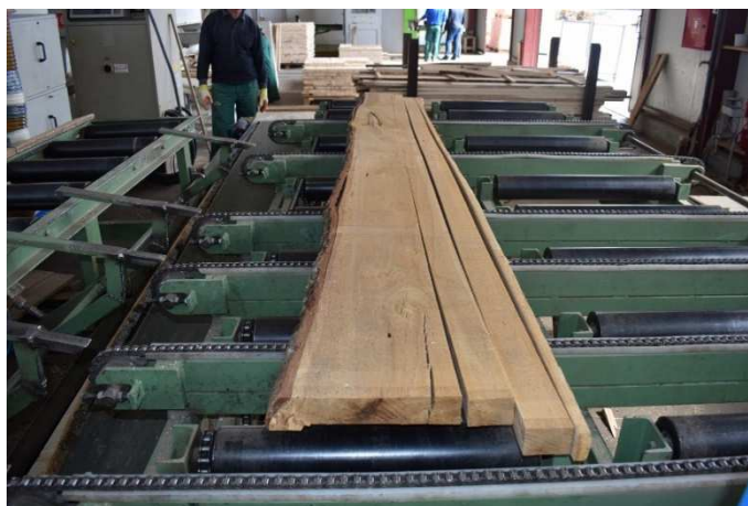
Slika 6. Hrastove greduke raspiljene na višelisnoj kružnoj pili.
