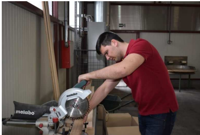
Slika 8. Izrada konačnih uzoraka pomoću potezne kružne pile.
