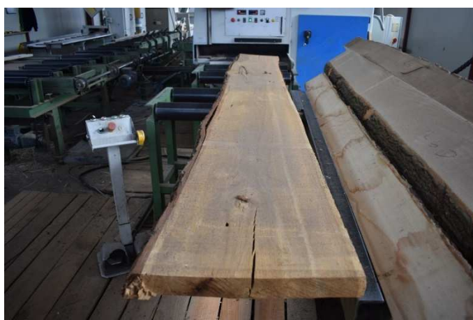
Slika 5. Raspiljivanje hrastovih piljenica na višelisnoj kružnoj pili.
