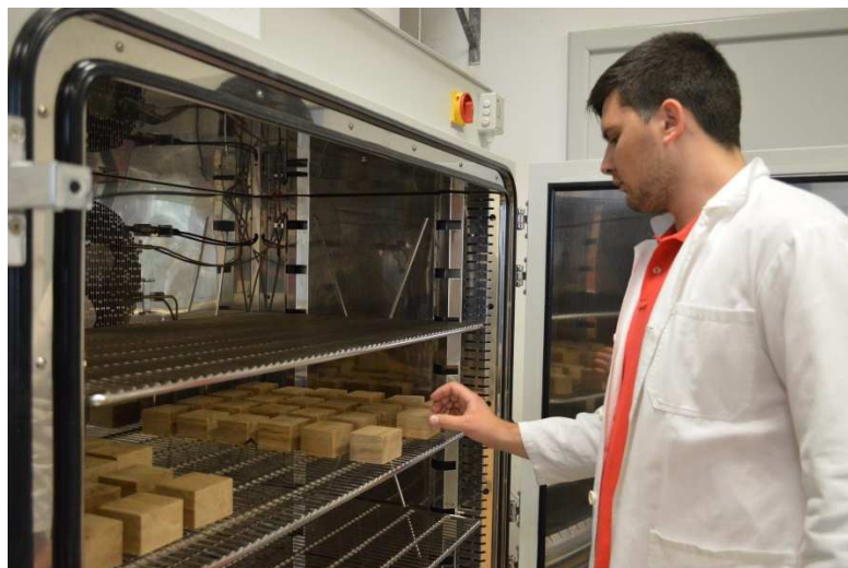
Slika 16. Slaganje uzoraka u klimatizacijsku komoru.
