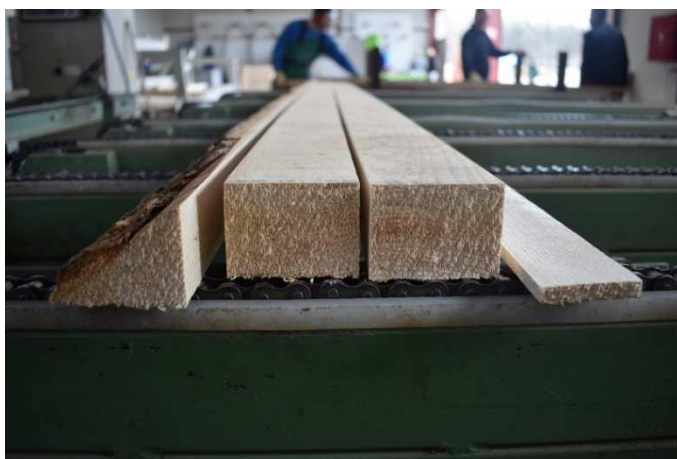
Slika 4. Jasenove gredice raspiljene na višelisnoj kružnoj pili.
