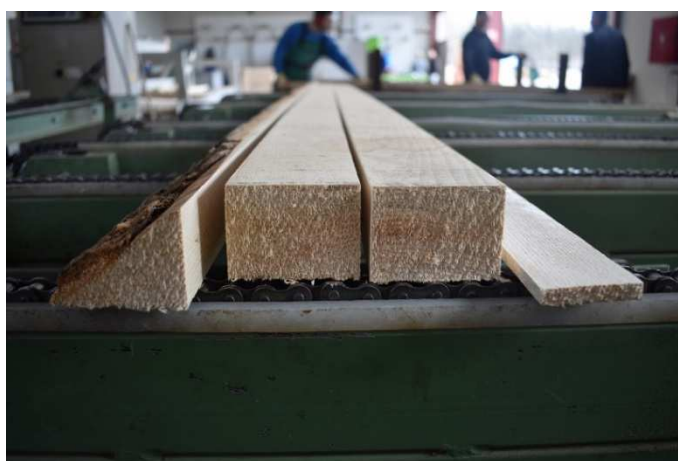
Slika 4. Jasenove gredice raspiljene na višelisnoj kružnoj pili.
