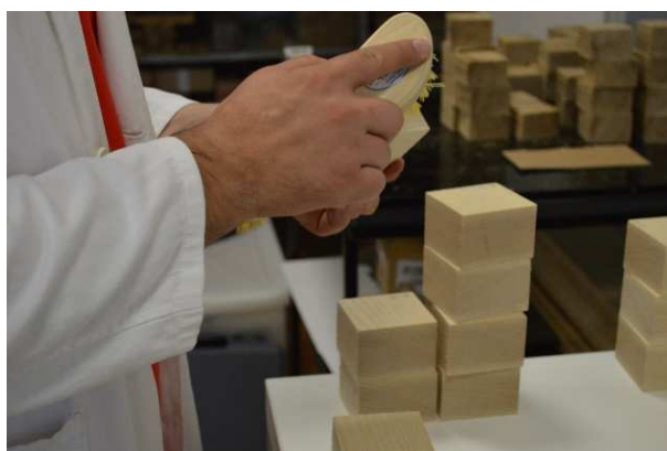
Slika 13. Čišćenje uzoraka pomoću četke.
