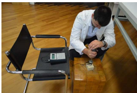
Slika 18. Zabijanje sonde elektrootpornog vlagomjera u uzorak.
