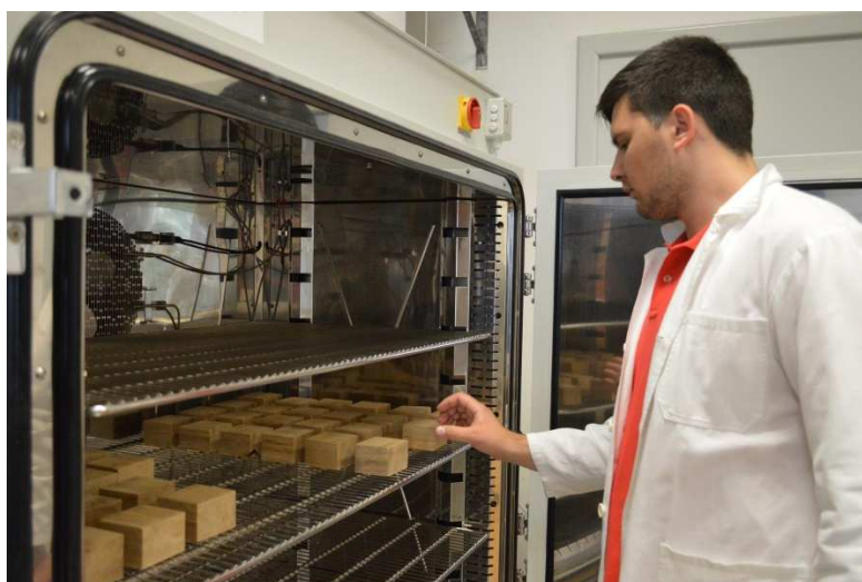
Slika 16. Slaganje uzoraka u klimatizacijsku komoru.
