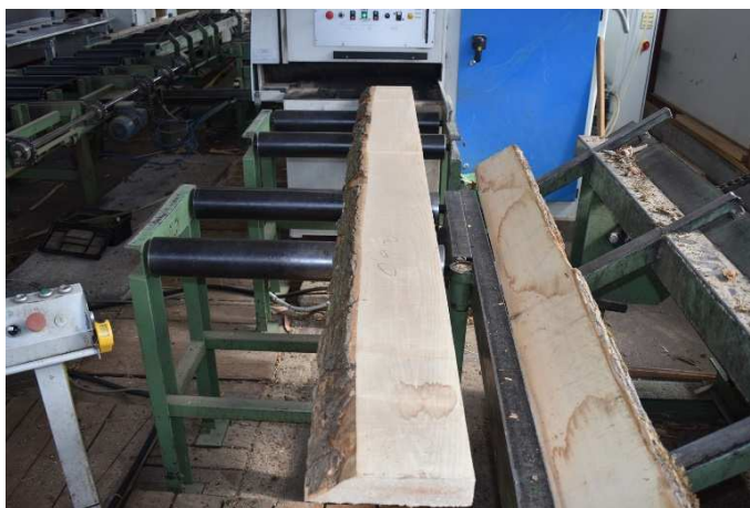
Slika 3. Raspiljivanje jasenovih piljenica na višelisnoj kružnoj pili.
