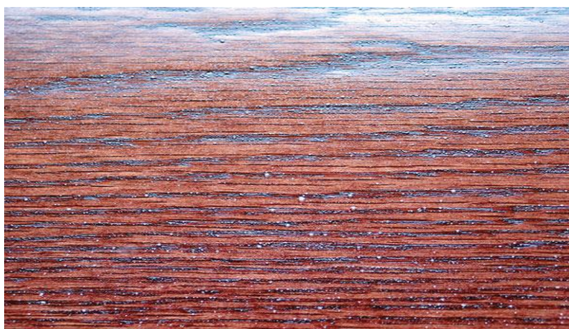
Slika 18. Nastajanje rupičastih oštećenja
