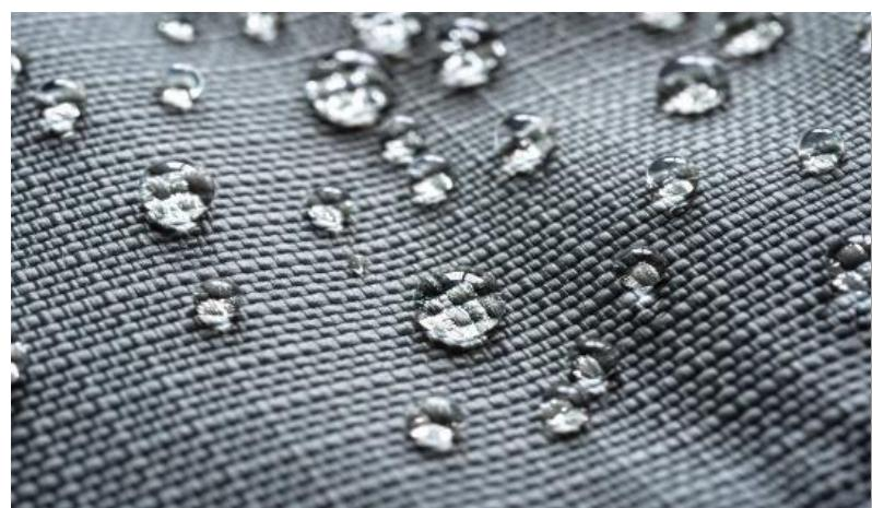
Slika 6. Sintetski hidrofoban materijal
