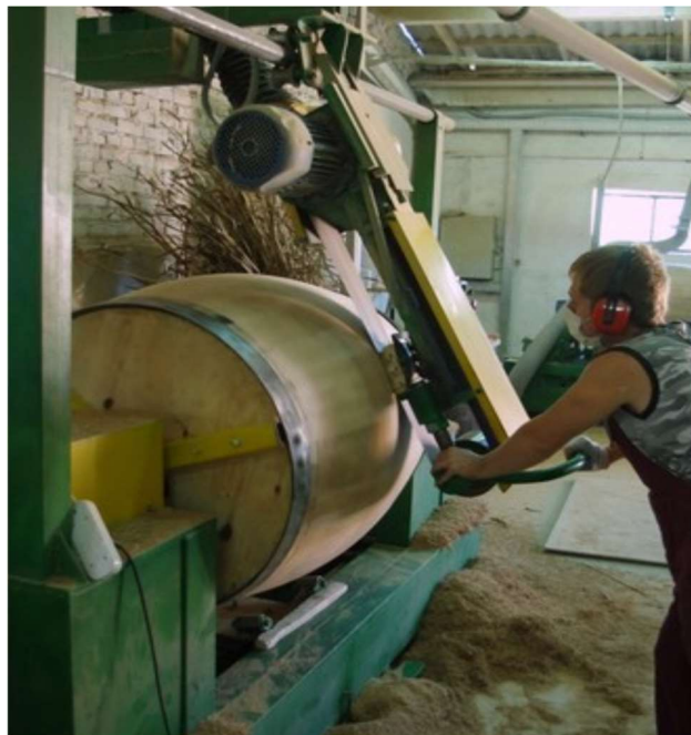
Slika 25. Prikaz strojnog brušenja bačve
