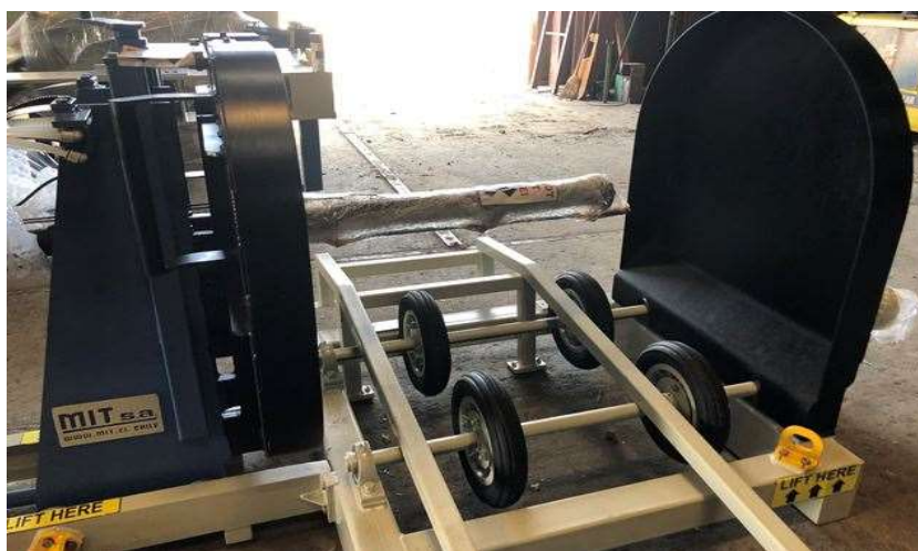
Slika 18. Stroj za paljenje unutrašnjosti bačve
