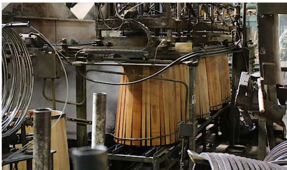
Slika 16. Parenje plašta bačve prije navlačenja drugog obruča
