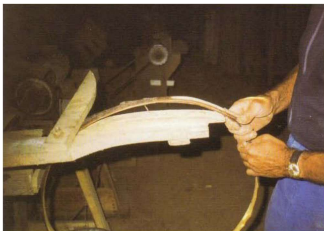
Slika 22. Ručno oblikovanje metalnog obruča (a) i stroj za oblikovanje metalnih obruča (b)
