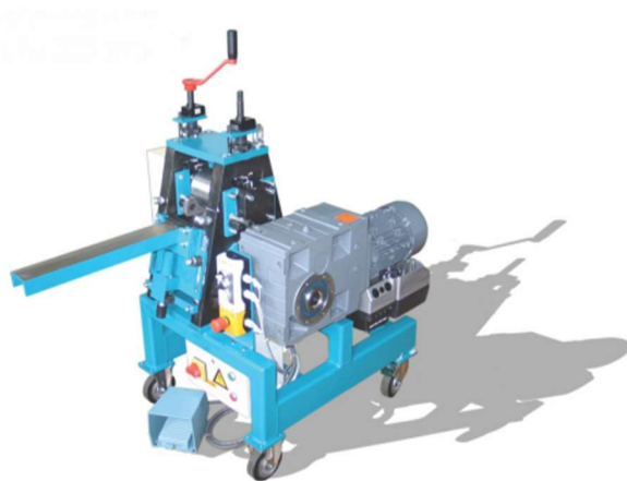
Slika 22. Ručno oblikovanje metalnog obruča (a) i stroj za oblikovanje metalnih obruča (b)
