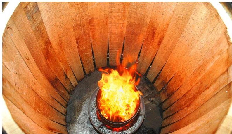
Slika 14. Unutrašnjost bačve i ložište prilikom oblikovanja plašta
