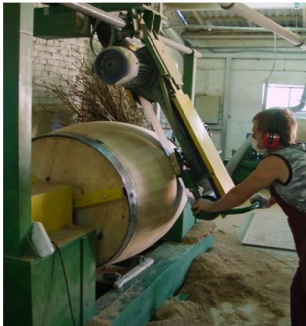
Slika 25. Prikaz strojnog brušenja bačve
