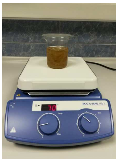
Slika 2. Otopanje polistirena u toluenu uz pomoć mješalice IKA C-MAG HS 7
