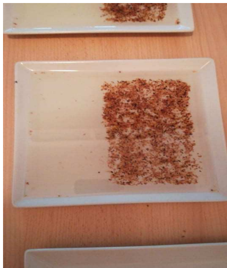
Slika 4. Polimer pomiješan s usitnjenom korom bagrema
