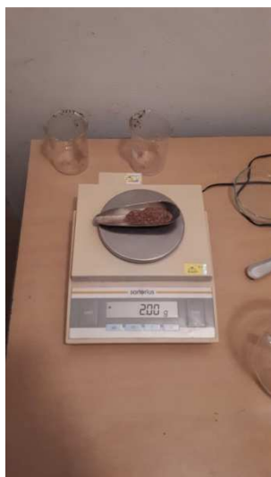
Slika 3. Vaganje usitnjene kore smreke
