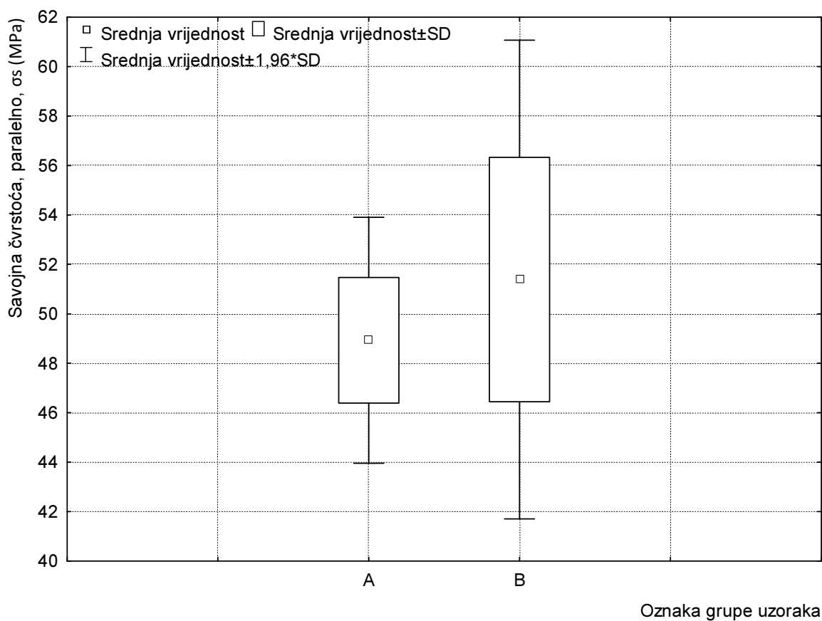
Slika 18. Grafički prikaz savojne čvrstoće pojedinih grupa uzoraka eksperimentalnihdrvno-plastičnih kompozita (paralelno sa smjerom vlakanaca fumira)
