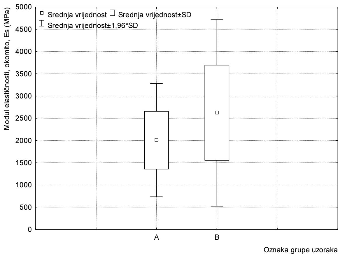
**Slika 21.** Grafički prikaz modula elastičnosti savojne čvrstoće pojedinih grupa uzoraka eksperimentalnih drvno-plastičnih kompozita (okomito na smjer vlakanaca fumira)
