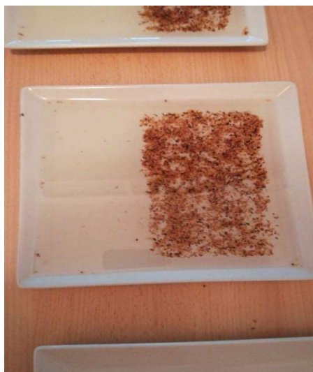
Slika 4. Polimer pomiješan s usitnjenom korom bagrema
