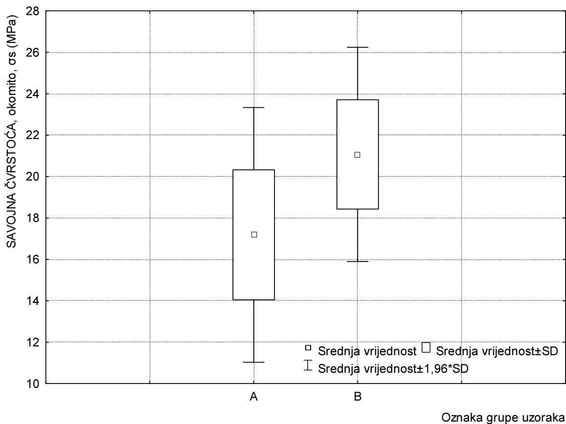
Slika 19. Grafički prikaz savojne čvrstoće pojedinih grupa uzoraka eksperimentalnih drvno-plastičnih kompozita (okomito na smjer vlakanaca furnira)
