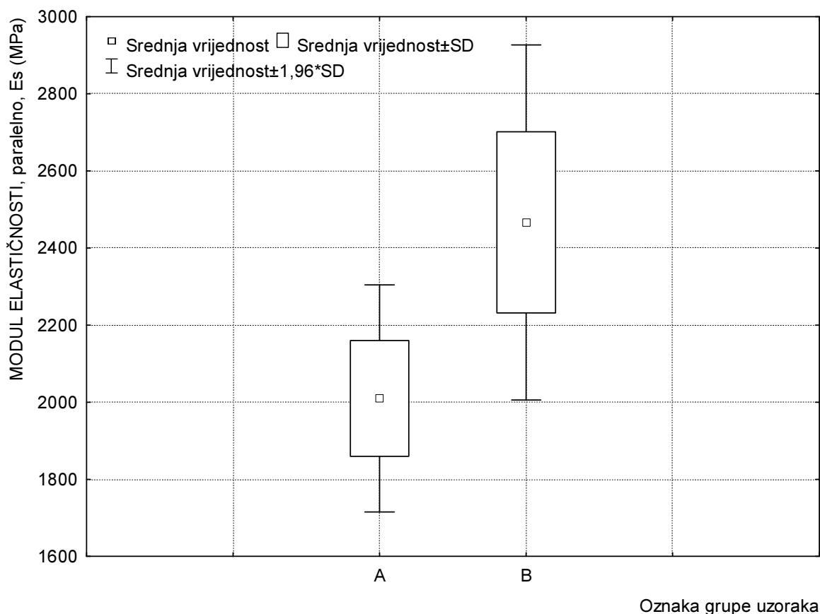
**Slika 20.** Grafički prikaz modula elastičnosti savojne čvrstoće pojedinih grupa uzoraka eksperimentalnih drvno-plastičnih kompozita (paralelno sa smjerom vlakanaca fumira)
