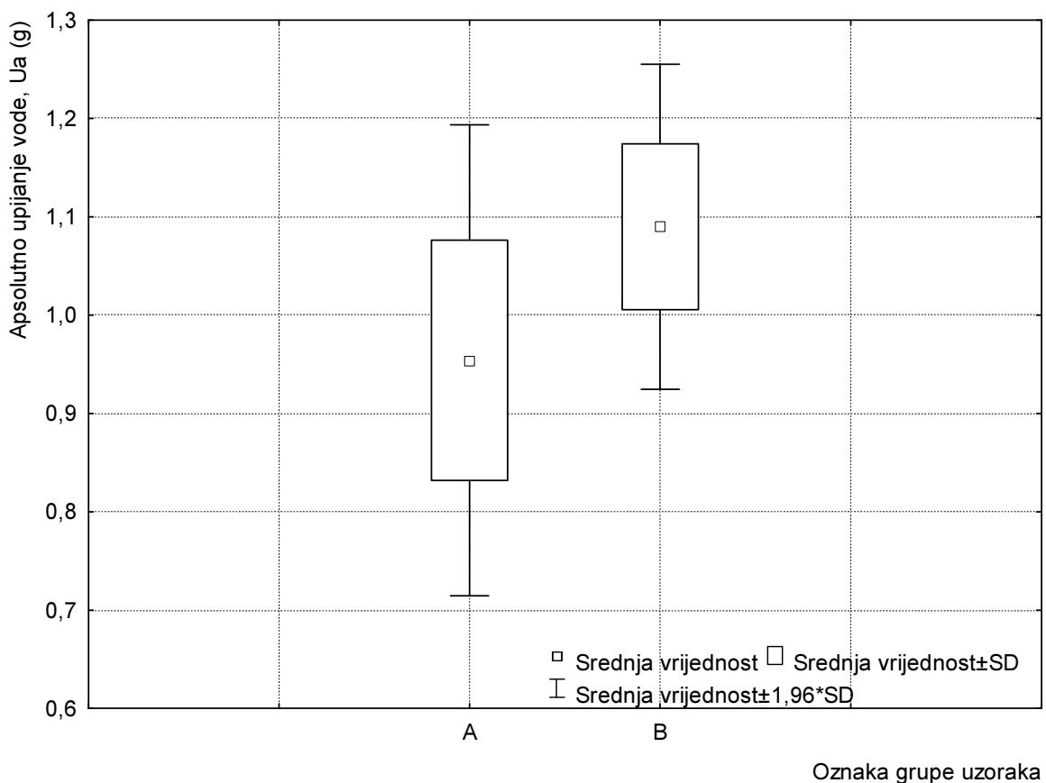
Slika 16. Grafički prikaz absolutnog upijanja vode pojedinih grupa uzoraka eksperimentalnih drvno-plastičnih kompozita
