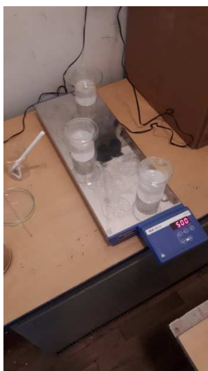
Slika 1. Otopanje polistirena u toluenu uz pomoć multipozicijske mješalice IKA RO 10
