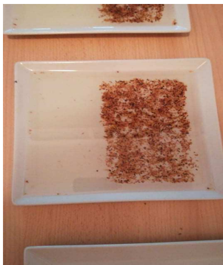
Slika 4. Polimer pomiješan s usitnjenom korom bagrema
