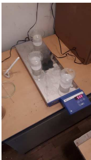
Slika 1. Otopanje polistirena u toluenu uz pomoć multipozicijske mješalice IKA RO 10
