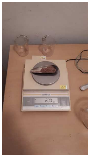
Slika 3. Vaganje usitnjene kore smreke
