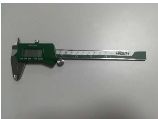
Slika 9. Digitalno pomično mjerilo
