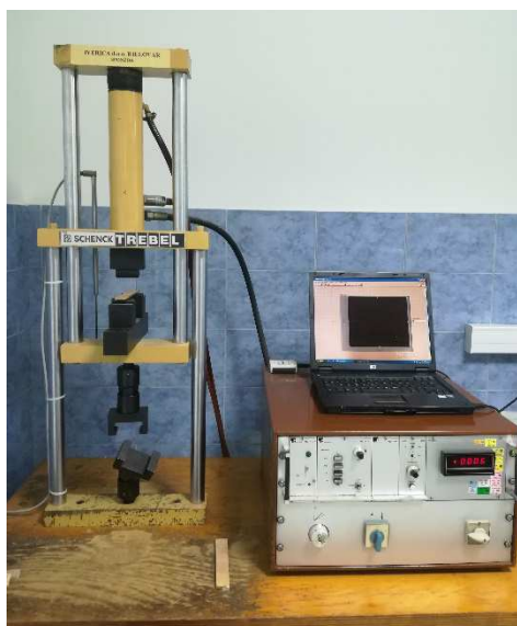
Slika 11. Kidalica za ispitivanje savojne čvrstoće i modula elastičnosti savojne čvrstoće
