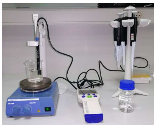
Slika 6. Digitalni pipetori Gilson Ultra i digitalni pH metar Mettler Toledo Seven GO
