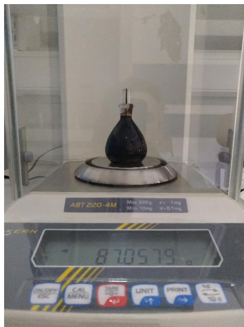
Slika 11. Vaganje punog piknometra
