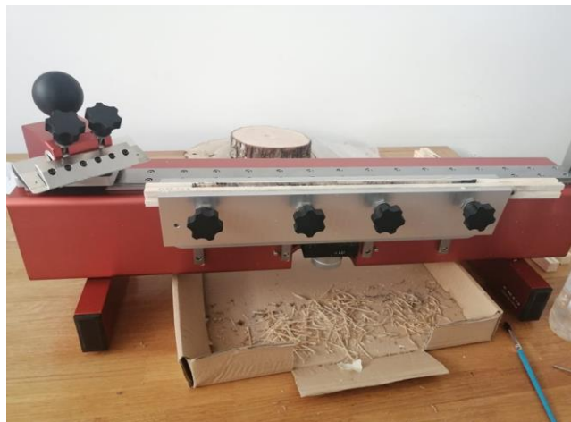
Slika 7. Uređaj microtom za pripremu uzoraka
