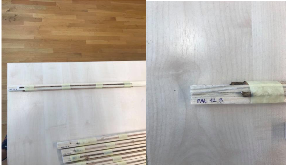
Slika 6. Ljepljenje i označavanje uzoraka na daščicama
