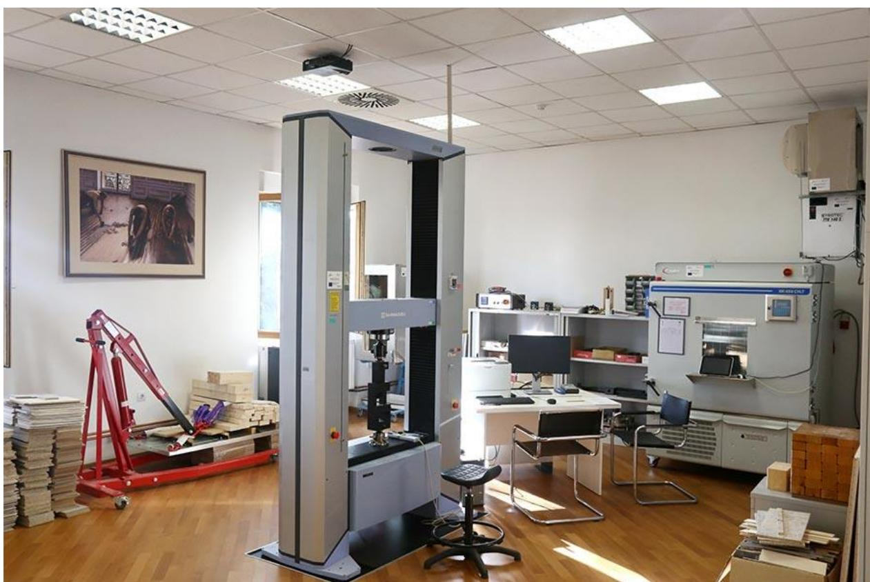
Slika 21. Kidalica Shimadzu
