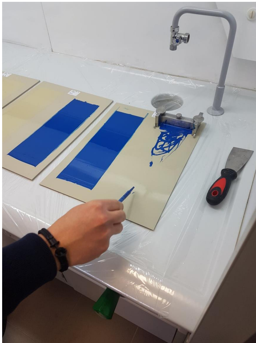
Slika 16. Nanošenje laka na podlogu
