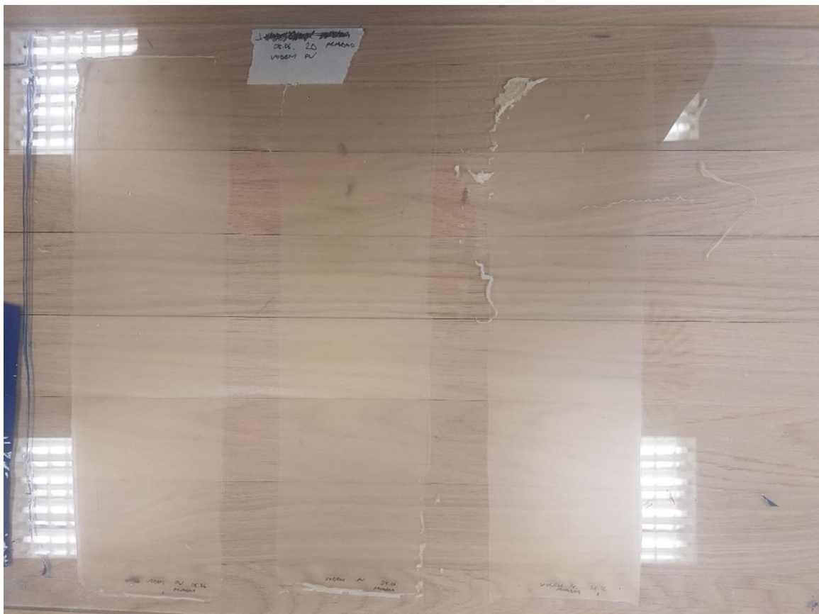
Slika 18. Vodeni PU 1K lak na staklu nakon sušenja
