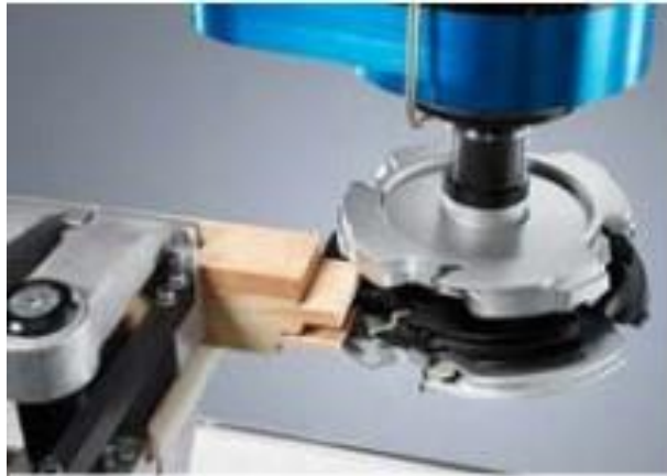
Slika 30. Izrada dvostrukog čepa i raskola (URL 8)
