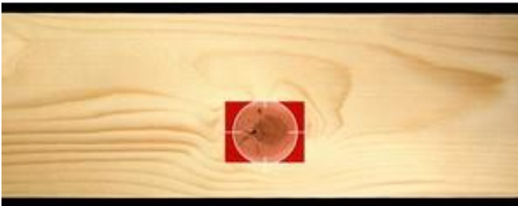
Slika 25. Korak 2 Obrada slike – Prepoznaje i klasificira greške kao i varijacije boja u piljenici (URL 30)
