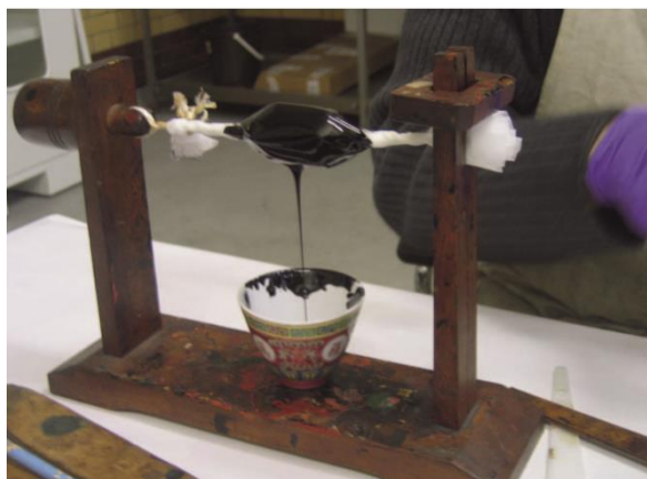
Slika 11. Filtracija urushia radi uklanjanja čestica prašine (McSharry i drugi, 2016)
