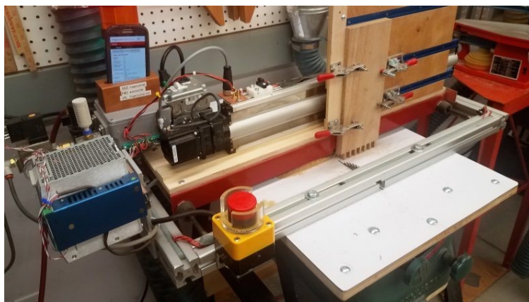
Slika 26 - Pametna računalno upravljana stolna pila
