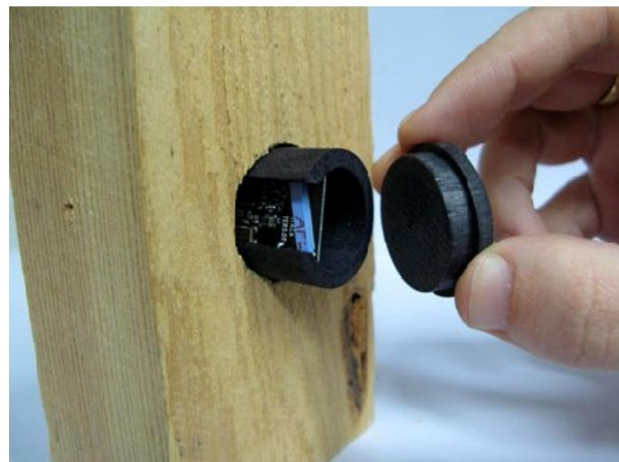
Slika 24 - Ugrađivanje IoT senzora u drvenu gredu
