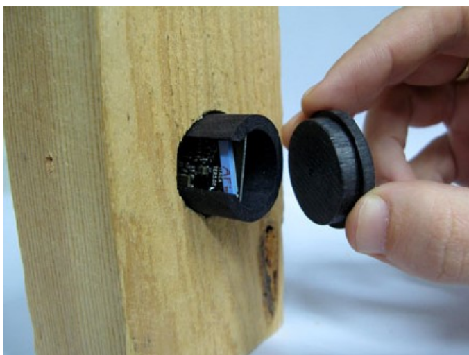
Slika 24 - Ugrađivanje IoT senzora u drvenu gredu
