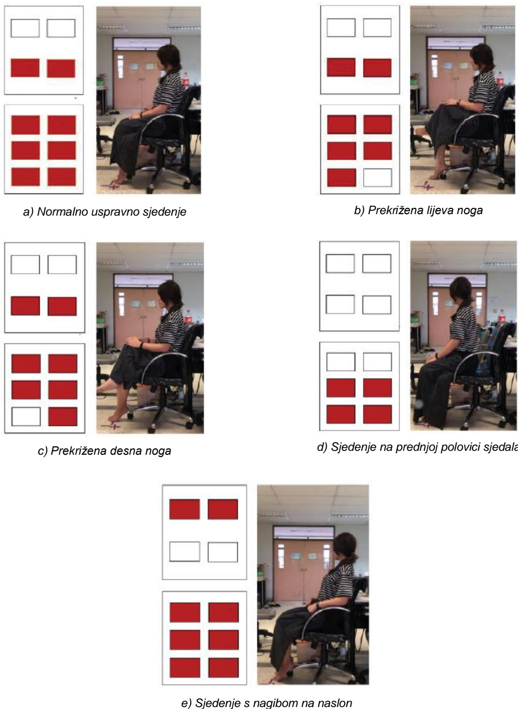
Slika 34. Načini sjedenja prilikom ispitivanja i aktivaciju senzora na stolici
