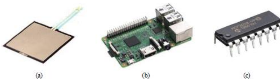
Slika 12. Prikaz komponenti sustava (a) senzor tlaka, (b) mikro računalo Raspberry Pi i (c) A/D pretvarač MCP 3008
