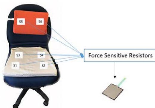
Slika 40. Prikaz ispitne stolice s FSR senzorima
