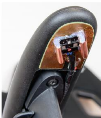
Slika 27. Prikaz PPG senzora u rukonaslonu pokusne stolice
