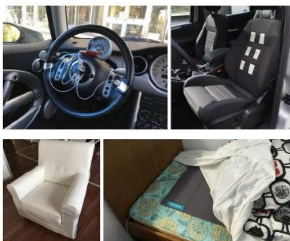
Slika 50. Prikaz EKG i cEKG senzora u automobilu i namještaju
