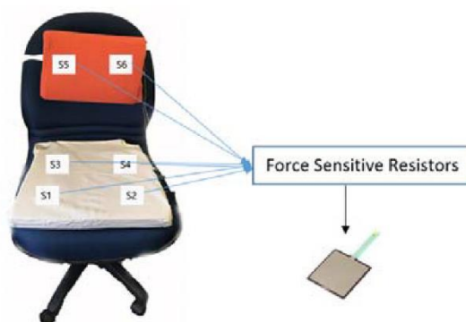
Slika 40. Prikaz ispitne stolice s FSR senzorima
