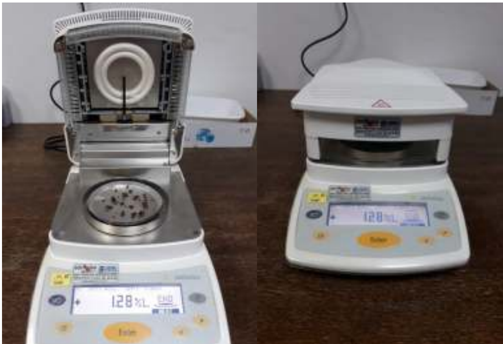
Slika 16: Određivanje sadržaja vode IC analizatorom Sartorius MA 150
