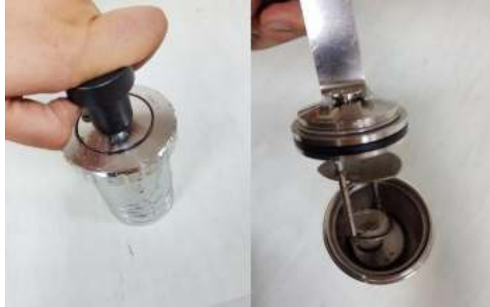
Slika 12: Ispuštanje kisika i pražnjenje kalorimetarska bombe
