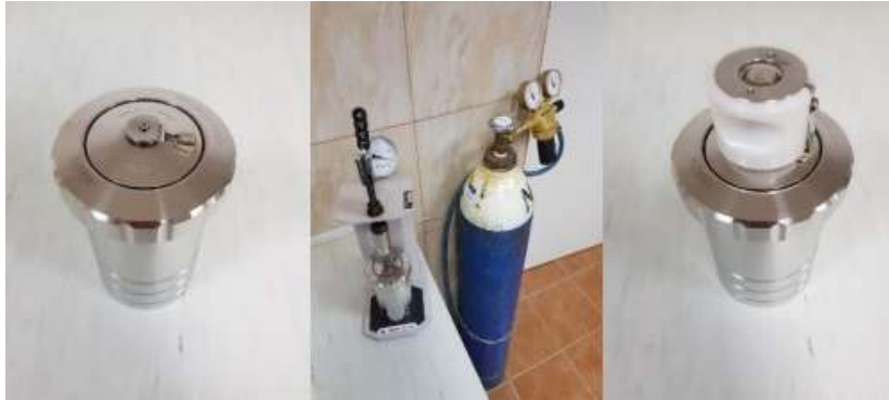
Slika 11: Zatvaranje kalorimetarske bombe i punjenje kisikom
