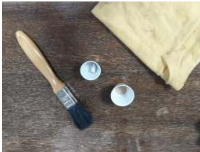
Slika 20: Porculanske posudice prije žarenja (desno) i poslije žarenja (lijevo) i pribor za čišćenje
