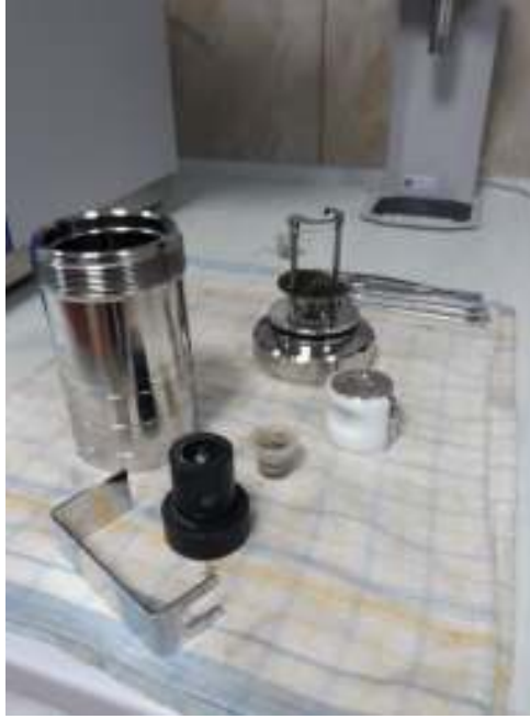
Slika 9: Dijelovi kalorimetarske bombe i oprema za rukovanje
