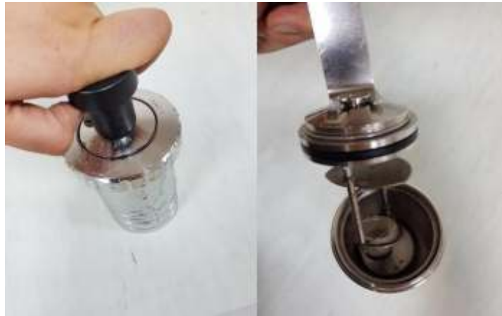
Slika 12: Ispuštanje kisika i pražnjenje kalorimetarska bombe
