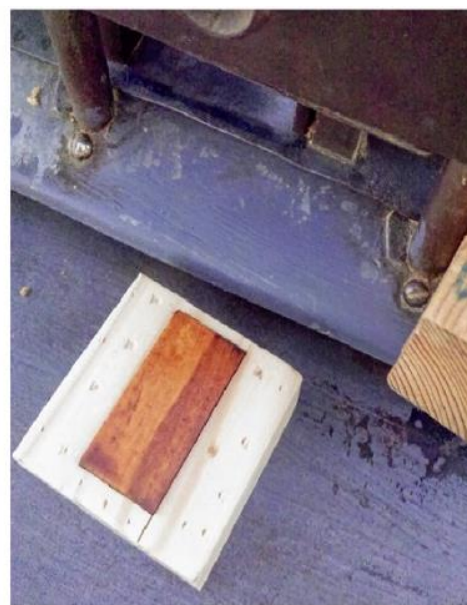
Slika 14 Uređaj za ispitivanje otpornosti protiv habanja prema Kollmann-u
