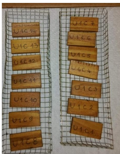
Slika 4 Uzorci nakon potapanja u BQ1 impregnaciju, a nakon sušenja površinski tretirani uljem Pflege-Öl
