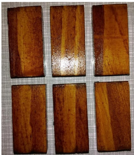
Slika 7 Uzorci nakon potapanja u HK-Lasur, a nakon sušenja površinski tretirani HWS-112
