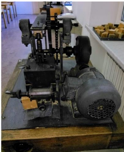
Slika 14 Uređaj za ispitivanje otpornosti protiv habanja prema Kollmann-u
