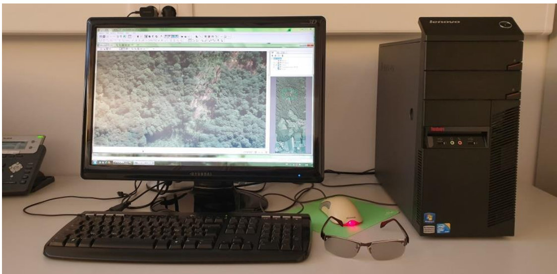
Slika 3. Digitalna fotogrametrijska stanica (DFS)
