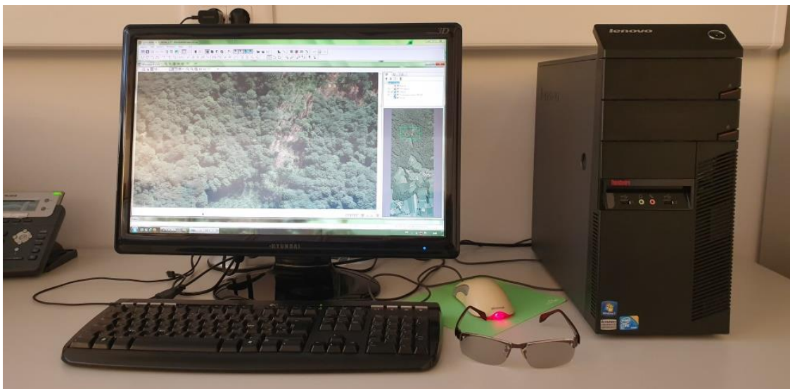
Slika 3. Digitalna fotogrametrijska stanica (DFS)
