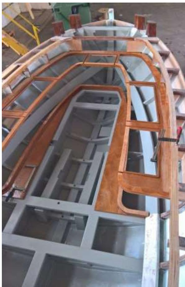
**Slika 27.** Unutrašnja konstrukcija broda
