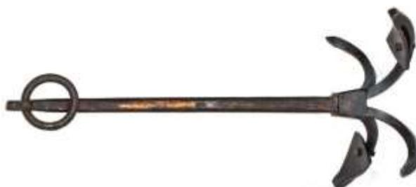
**Slika 6.** Brodsko sidro. (Najvažniji popratni zanat uz brodogradnju bio je mukotrpnji zanat kovača, danas gotovo izumrli zanat koji je majstore opskrbljivao alatom i ostalom kovanom brodskom opremom).
