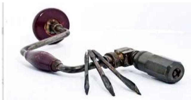
**Slika 3.** Starinska ručna bušilica za bušenje provrta.
