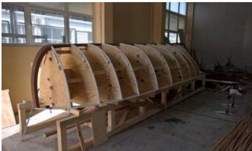
Slika 25. Kalup za izradu gajete
