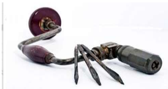
Slika 3. Starinska ručna bušilica za bušenje provrta.
