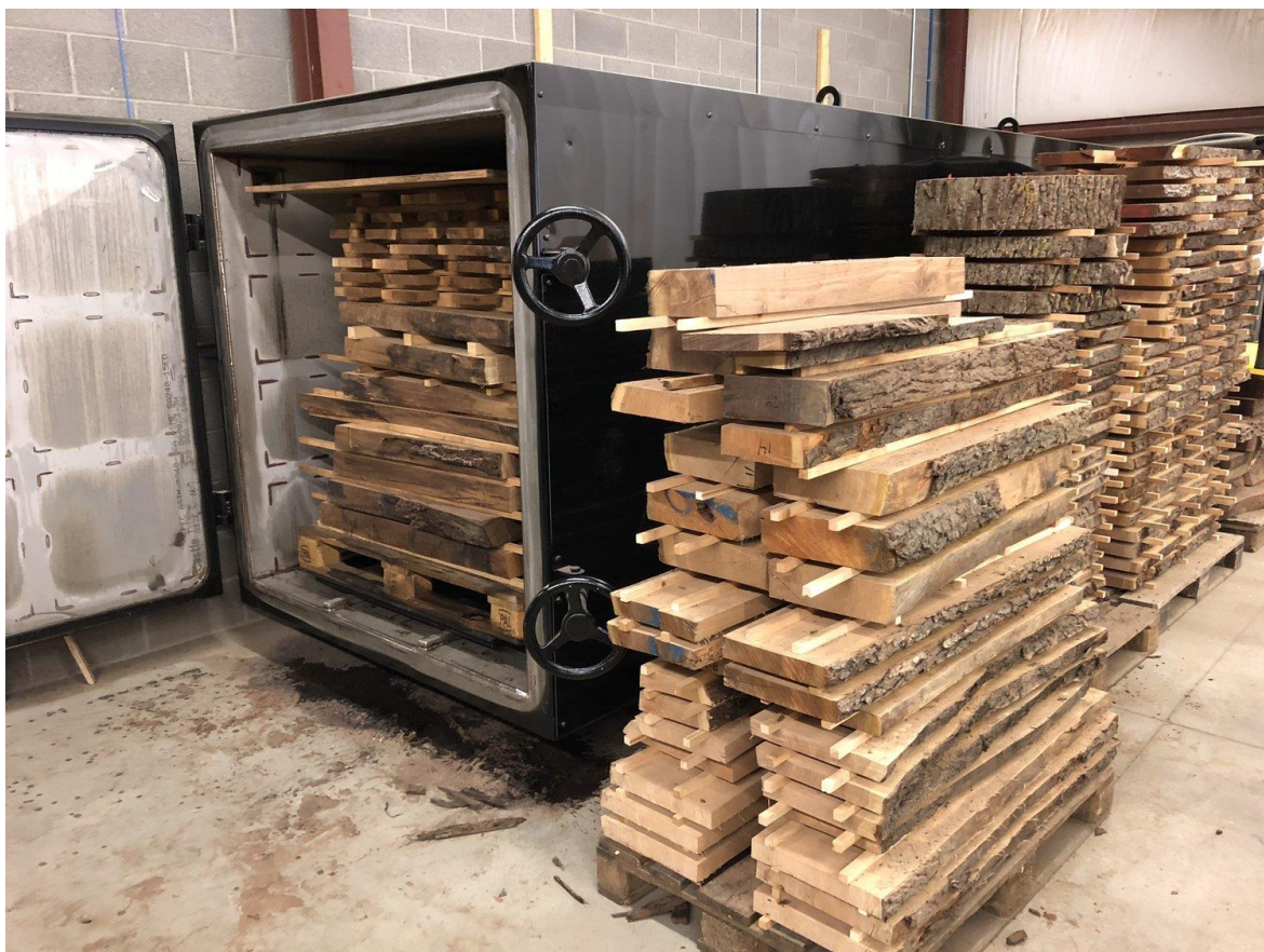
Slika 8. Sušenje cirkulacijom zagrijanog zraka (izvor: https://idrywood.com/idry-standard , 15.8.2020.)
