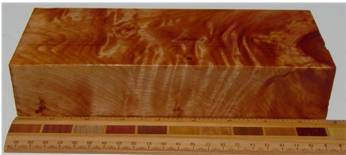
Slika 13. Uzorak južne bukve nakon sušenja (izvor: VacDryKilns, 15.8.2020.)
