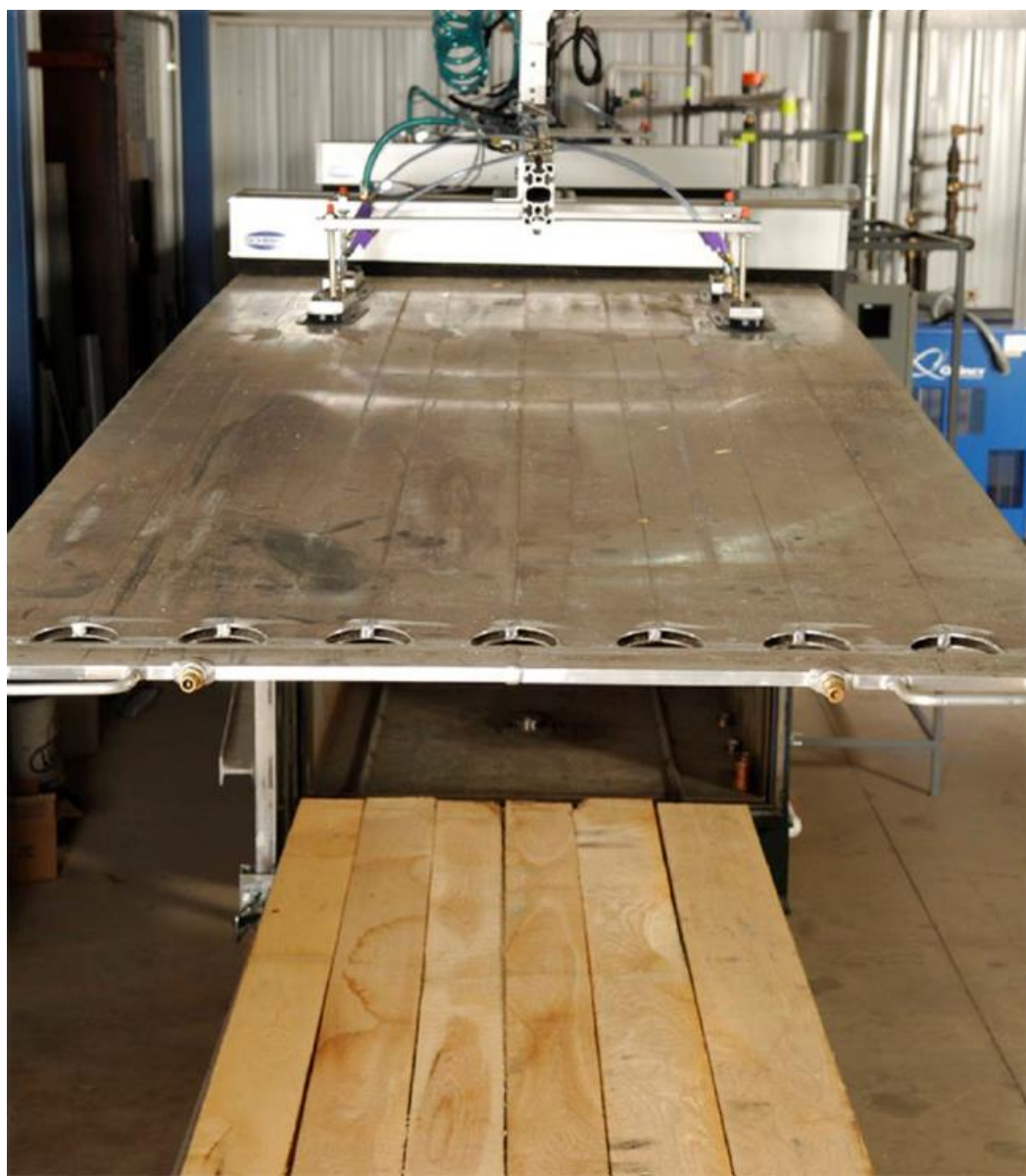
Slika 7. Manipulacija grijaćih ploča (izvor: https://idrywood.com/idry-standard , 15.8.2020.).
