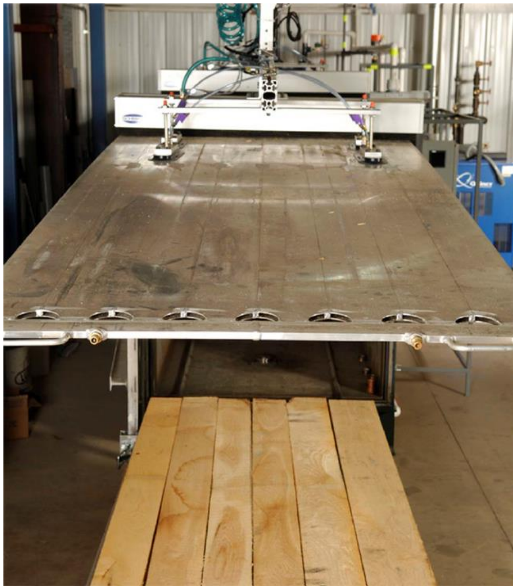
Slika 7. Manipulacija grijaćih ploča (izvor: https://idrywood.com/idry-standard , 15.8.2020.).
