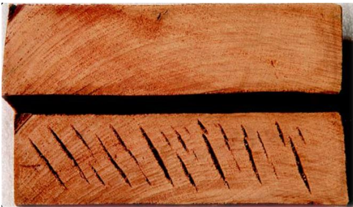
Slika 12. Uzorak nakon sušenja (izvor: VacDryKilns, 15.8.2020.)
