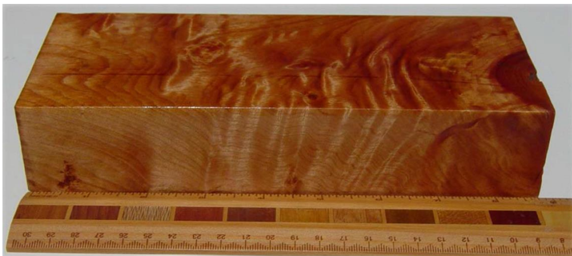
Slika 13. Uzorak južne bukve nakon sušenja (izvor: VacDryKilns, 15.8.2020.)
