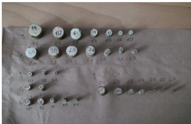
**Slika 9.** Priprema uzoraka stabalaca amorfne za laboratorijsku obradu
