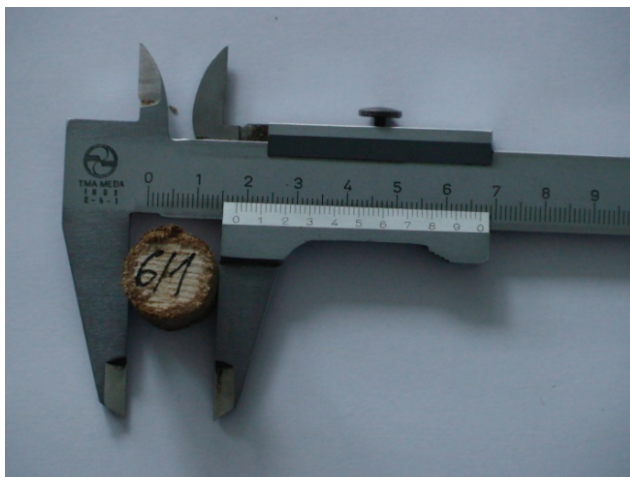
Slika 10. Stereometrijsko određivanje obujma uzoraka
