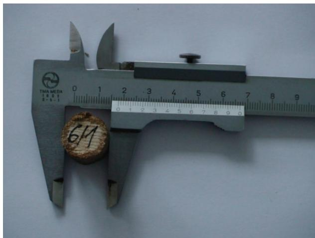
**Slika 10.** Stereometrijsko određivanje obujma uzorka
