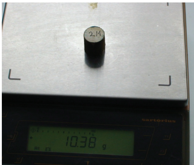
Slika 11. Mjerenje mase uzorka Figure 11 Sample mass determination
