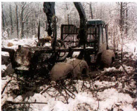
Figure 13. Limited soil strength Slika 13. Tlo ograničene nosivosti
