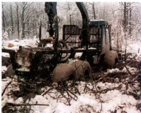
Figure 13. Limited soil strength Slika 13. Tlo ograničene nosivosti
