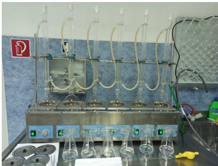
Slika 10. Aparatura za izolaciju celuloze
