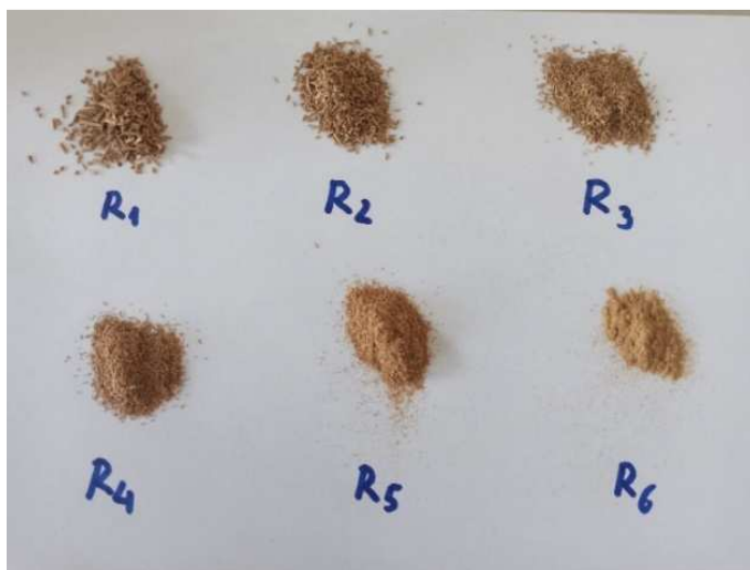
Slika 7. Drvno brašno nakon prosijavanja po frakcijama
