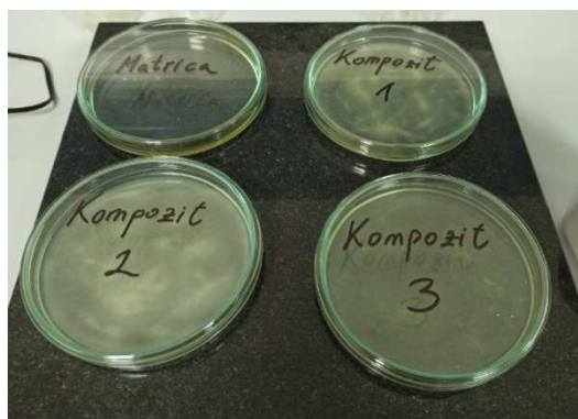
Slika 23. Formirani filmovi matrice i biokompozita
