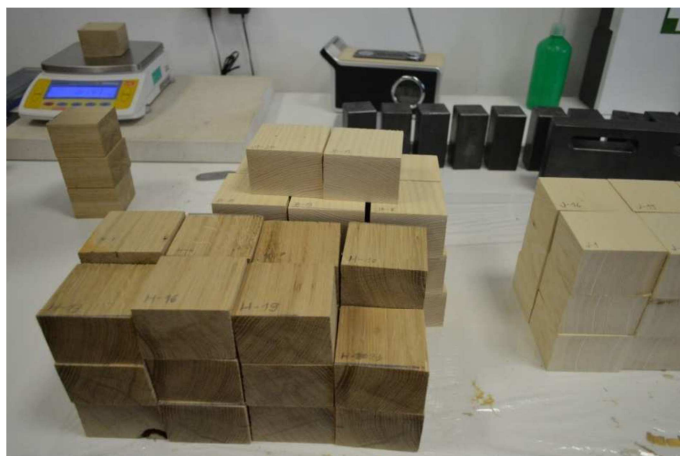
Slika 6. Uzorci hrastovine i jasenovine (Izvor: Crnojević, 2019)
