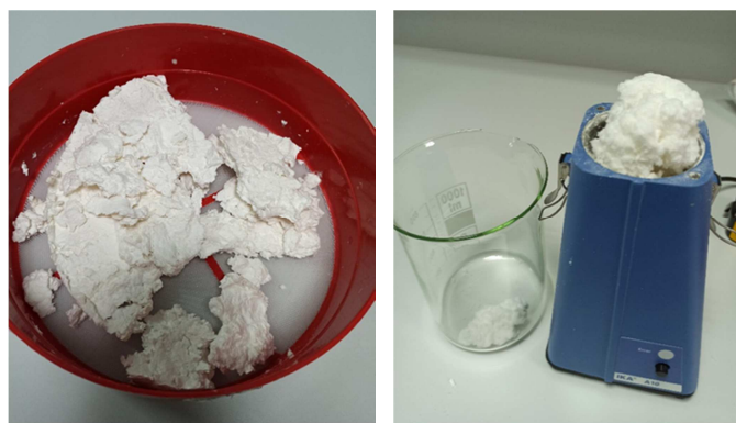
Slika 17. Holoceluloza nakon sušenja (lijevo) i holoceluloza pri usitnjavanju (desno)
