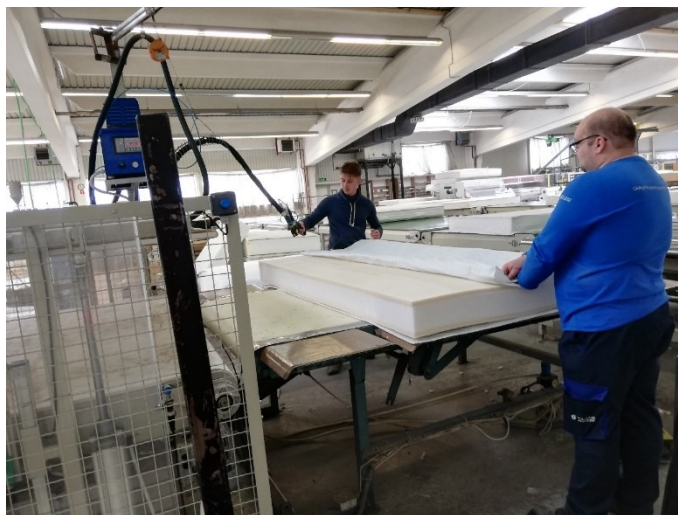
Slika 18. Obljepljivanje nosivog sloja madraca sa s ploham navlake
