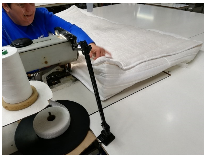
Slika 29. Šivanje gornje plohe i bordera pomoću tape-edge stroja
