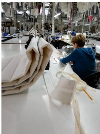
Slika 27. Šivanje patentnog zatvarača na border
