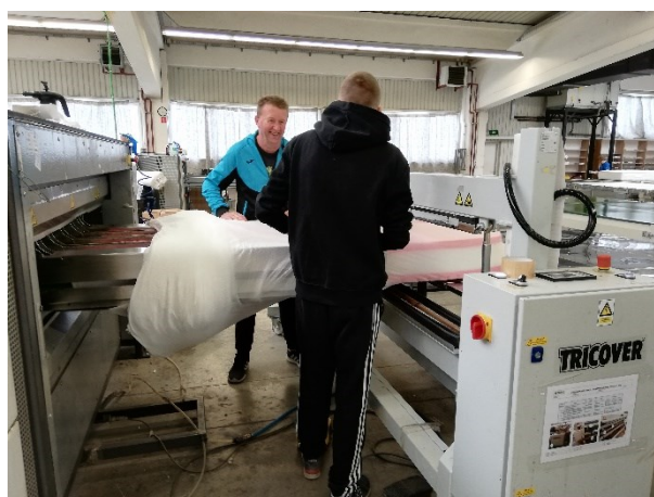
b) navlačenje triko navlake
