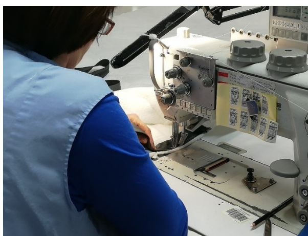
Slika 45. Šivanje patentnog zatvarača na plohu
