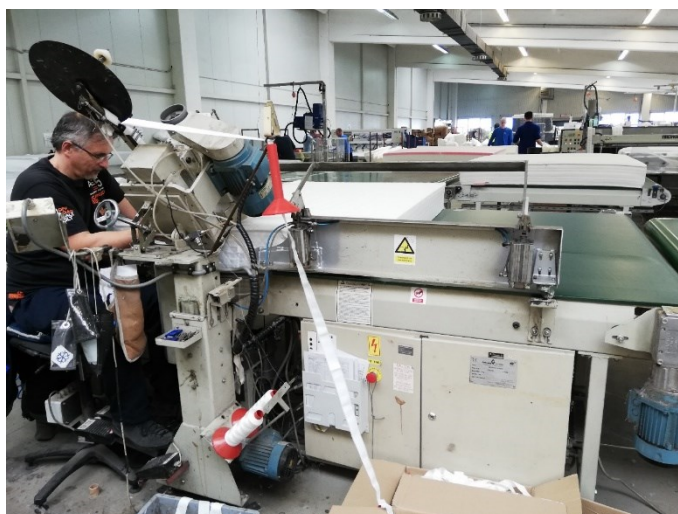
Slika 19. Šivanje rubova navlake pomoću tape-edge šivaćeg stroja
