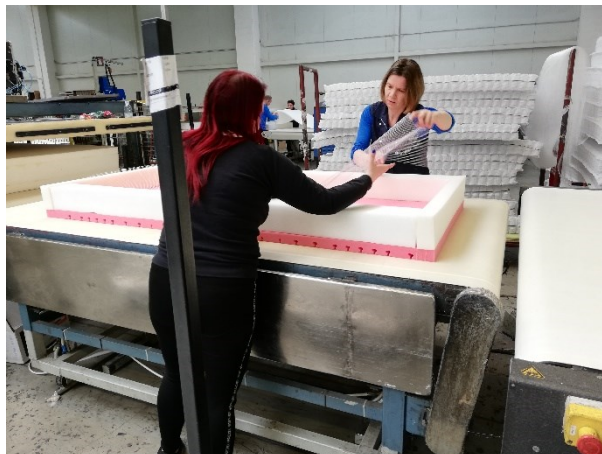
Slika 34. Umetanje propex mreže
