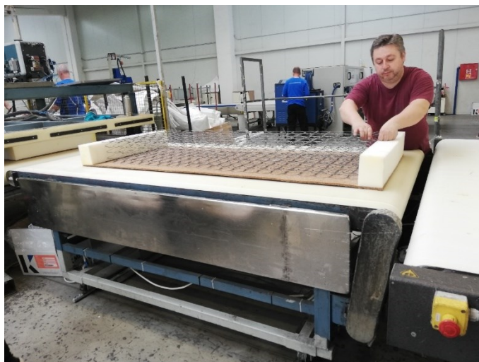
Slika 16. Sastavljanje nosivog sloja madraca
