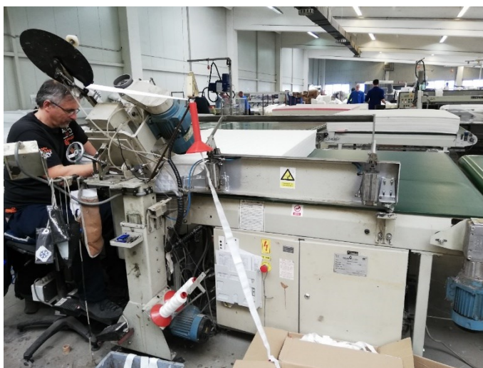
Slika 19. Šivanje rubova navlake pomoću tape-edge šivaćeg stroja
