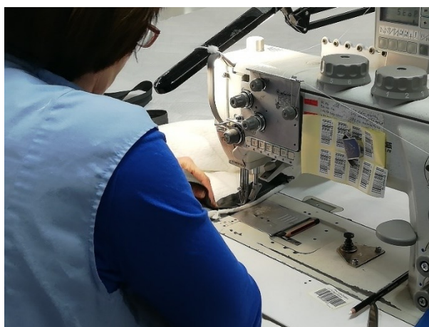
Slika 45. Šivanje patentnog zatvarača na plohu
