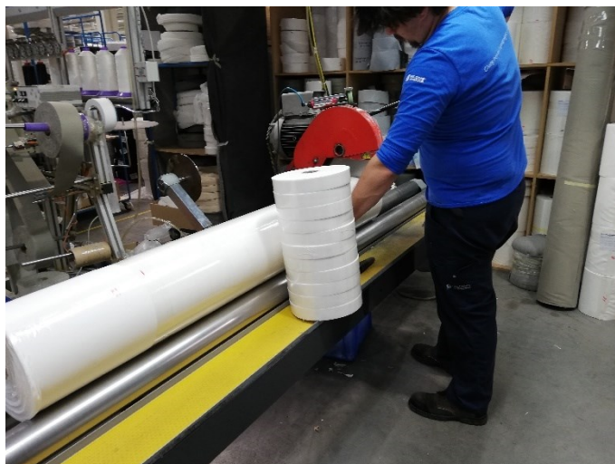
Slika 22. Rezanje bale 3D-mesh-a
