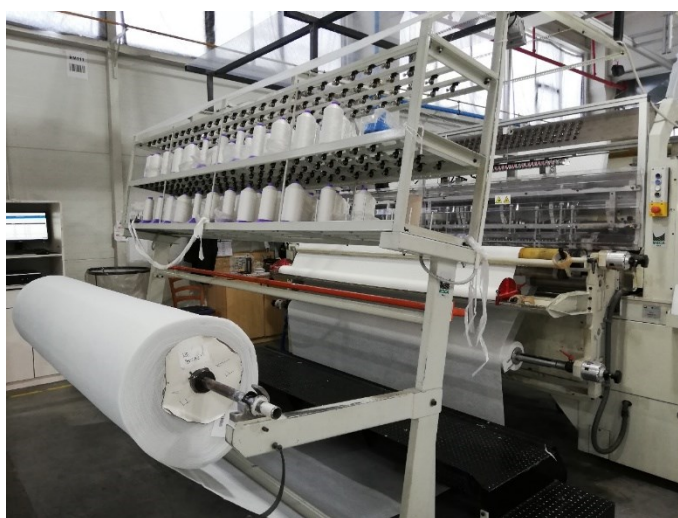
Slika 4. Ulazak repro materijala u višeični šivaći stroj
