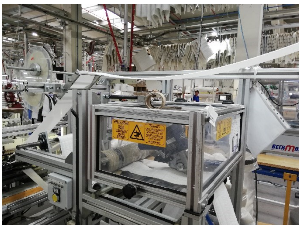
Slika 23. Rezanje bordera na dva dijela
