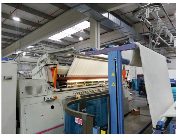
Slika 25. Šivanje ploha na višeglenom šivaćem stroju
