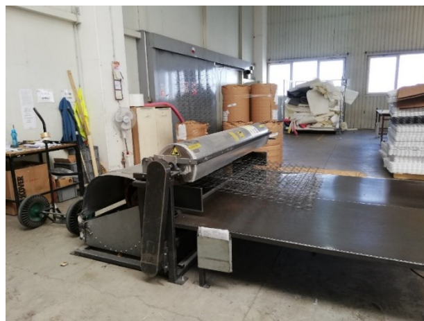
Slika 14. Odmotavanje bale s opružnim jezgrama
