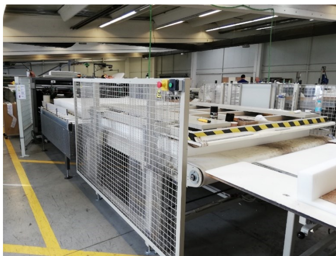
Slika 17. Prešanje nosivog sloja madraca
