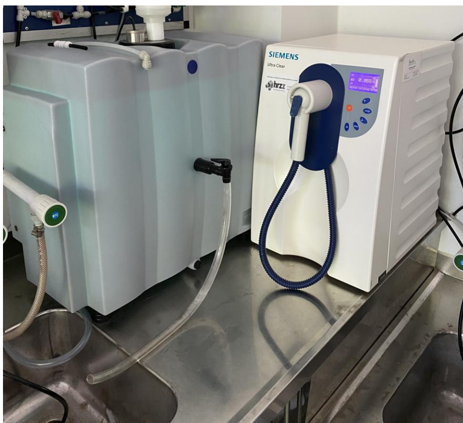
Slika 1. Siemens Ultra clear - uređaj za pročišćivanje vode
