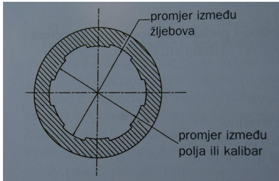
Slika 6: Poprečni presjek užljebljene cijevi (izvor: Mustapić Z. i sur., 2004.: Lovstvo.
