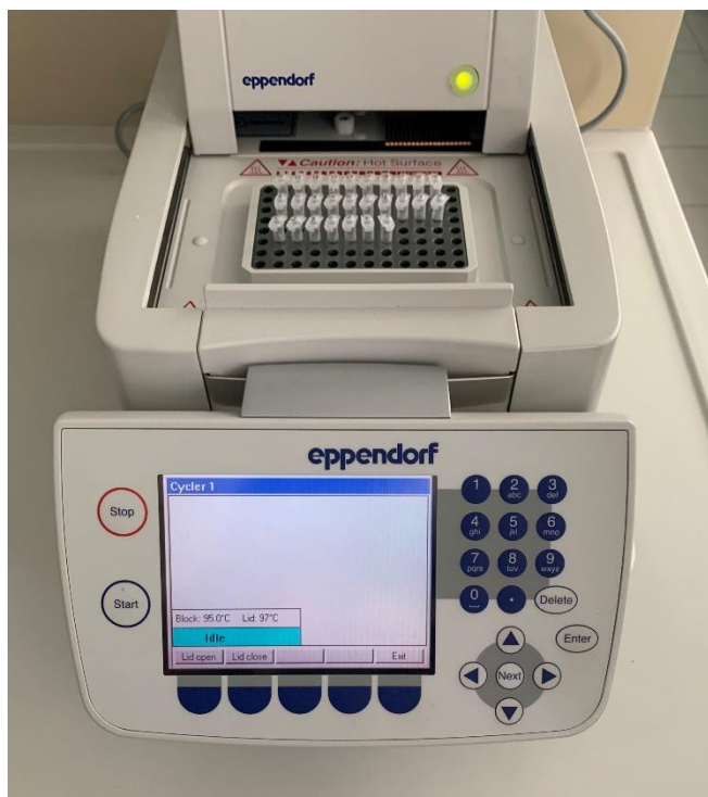
Slika 14. Uređaj za PCR sa ukupno 27 uzoraka: 26 uzoraka DNK i jednim kontrolnim
