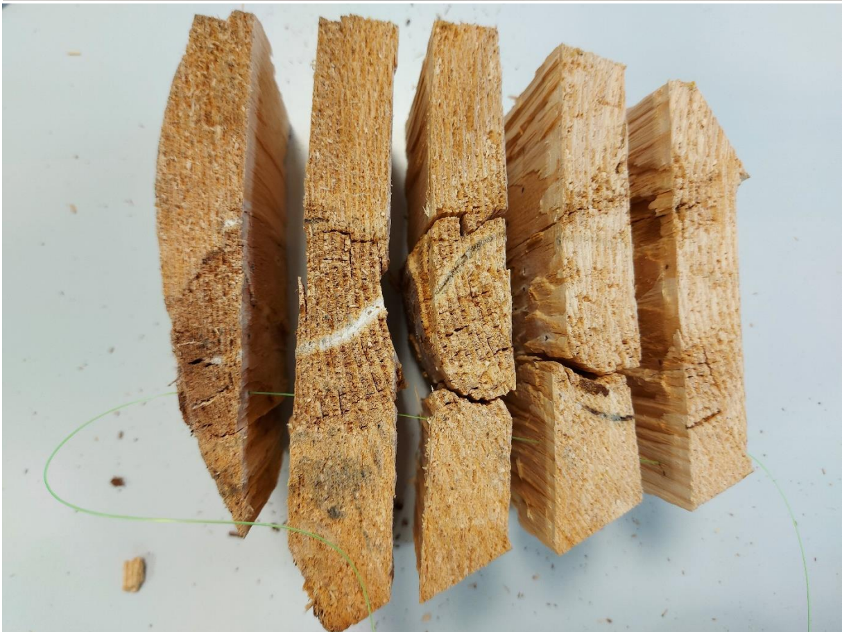
Slike 8 i 9: Provlačenjem niti može se utvrditi smjer i napredovanje galerijskog sustava jelinog valjkastog srčikara
